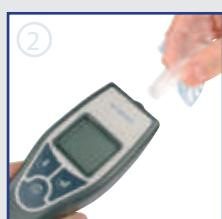
Inserire il boccaglio EnviteC nell'apposito beccuccio di AlcoQuant™ 6020 plus. Per ogni misurazione in modalità attiva deve essere utilizzato un nuovo boccaglio.
