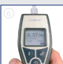
Il valore della misurazione viene visualizzato sul monitor e memorizzato. Premendo OK, lo strumento si predisponde per una nuova misurazione.
