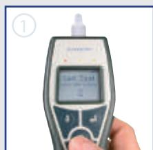
Dopo l'accensione l'apparecchio passa automaticamente alla modalità di misurazione attiva, si accende il LED verde, sul display compare "Pronto".
